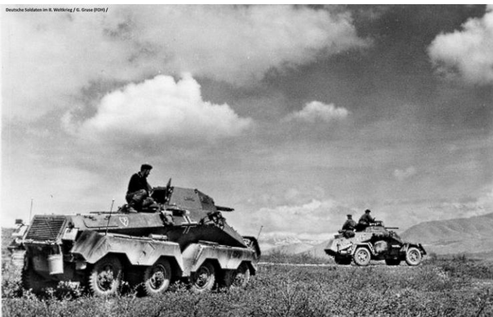
Zwei Panzerspähwagen der LAH in Griechenland 1941. Vorne links ein Sd.Kfz. 231, schwerer Panzerspähwagen (8-Rad), hinten rechts ein Sd.Kfz. 222 (könnte aber auch ein 221 sein).
